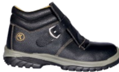
36140 EBRO EN ISO 20345 S3 SRC Calzatura alta specifica per saldatori in pelle fiore stampata, copri soffietto (elastico e non lacci) para scorie, chiusura con fibbia a sfilamento rapido. Cuciture in fibra aramidica che determinano una maggior resistenza della scarpa ma soprattutto a una protezione dalle scintille della saldatura. Suola in PU bidensità.
