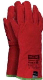
07121K GUANTO IN PELLE TUTTO CROSTA DI BOVINO Guanto in crosta di bovino superiore trattata anti-calore (TH1). Resiste 15 secondi al calore per contatto con temperatura 100°. Salvacuciture in Kevlar, palmo e dorso manichetta foderata. Lunghezza totale cm 38. Taglia: 10 Imballo: 60 pa. (mazzette da 6 pa.)
