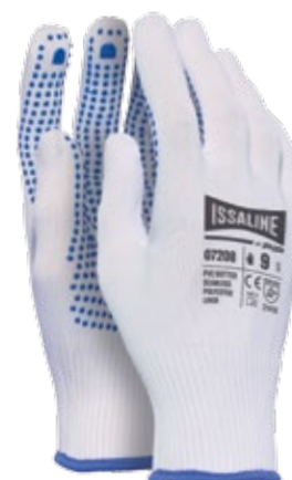
EN 388:2016 2141X 07208 GUANTO POLIESTERE PUNTINATO EN 388 4121X Guanto a maglia filo continuo puntinato sul lato palmo e dita. Filato: poliestere Colore filato: bianco Puntinato: PVC Colore puntinato: blu Taglie: 6-7-8-9-10 Mazzette: 12 pa. Imballo: 240 pa.
